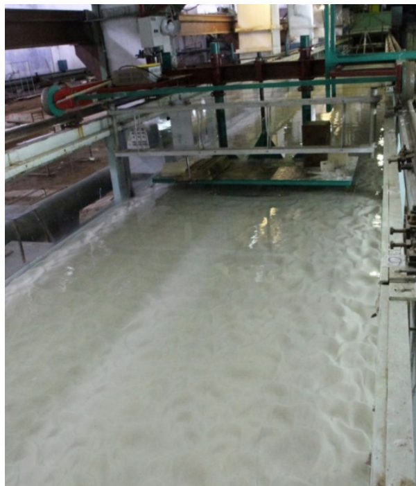
Рис. 2. Вид 50-метрового гидравлического лотка со стороны бака с водосливом (а) и вид тележки с измерительным оборудованием (б)
