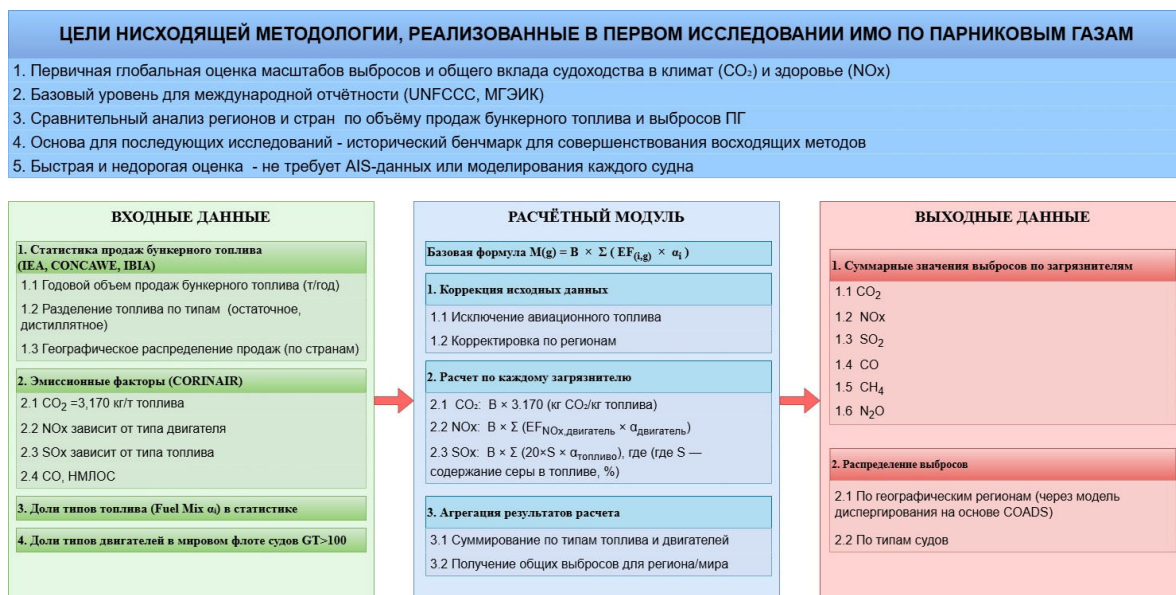
Рис. 1. Блок-схема нисходящей методологии, реализованной в Первом исследовании ИМО по парниковым газам [2]
