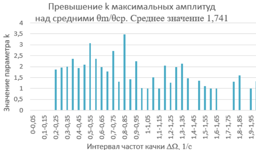
Рис. 4. Коэффициент k превышения средних интервальных амплитуд качки Fig. 4. Coefficient k of Exceedance over Mean Interval Roll Amplitudes
