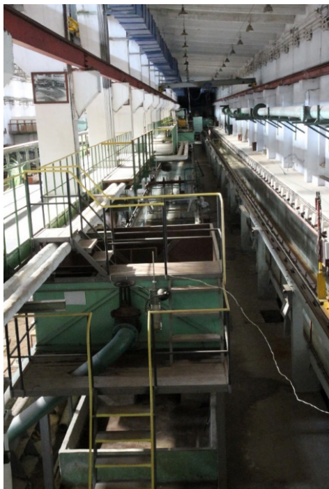
Рис. 2. Вид 50-метрового гидравлического лотка со стороны бака с водосливом (а) и вид тележки с измерительным оборудованием (б)
