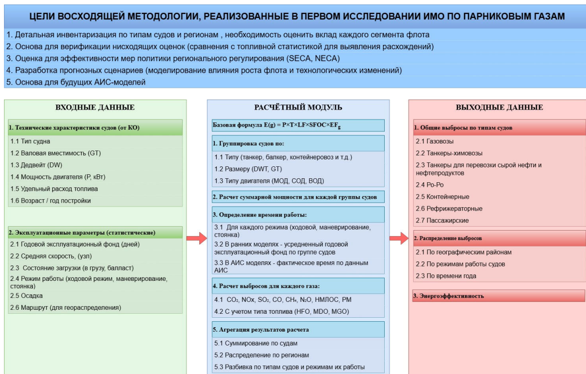
Рис. 2. Блок-схема восходящей методологии, реализованной в Первом исследовании ИМО по парниковым газам [2]
