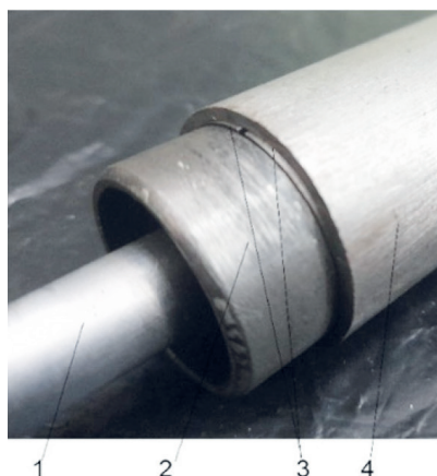
Рис. 2. Внешний вид сопряжения «поршень — цилиндр»: 1 — шток; 2 — поршень; 3 — сегменты кольца; 4 — сменный цилиндр Fig. 2. General view of the “piston–cylinder” friction pair: 1 — rod; 2 — piston; 3 — ring segments; 4 — replaceable cylinder
