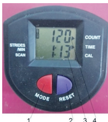
Рис. 3. Внешний вид узлов управления и цифрового индирования счетчика двойных ходов: 1, 2 — кнопки «Режим» и «Сброс»; 3, 4 — цифровые показания Fig. 3. General view of control units and digital display of the double-stroke counter: 1, 2 — “Mode” and “Reset” buttons; 3, 4 — digital readings
