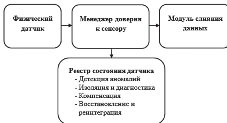
Рис. 2. Трехуровневая архитектура ССО с учетом протокола управления соединением датчиков Fig. 2. Three-layer architecture of the situational awareness system with consideration of the sensor connection management protocol
