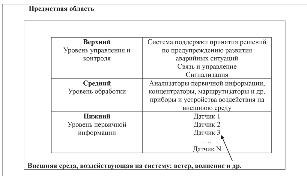
Рис. 2. Трехуровневая организация системы автоматического управления МАНС с учетом внешнего воздействия Fig. 2. Three-level organization of the automatic control system for MASS under external disturbances
