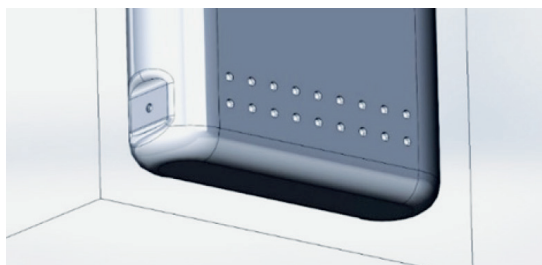
Рис. 6. Точки возможного размещения датчиков статического давления
