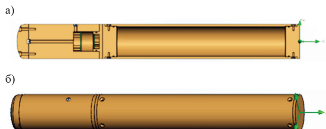
Рис. 1. Корпус гидродинамического лага нового типа: а — трубка лага в разрезе; б — внешний вид трубки лага
