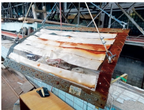
Рис. 1. Ленточный гидродинамический якорь в опытовом бассейне
