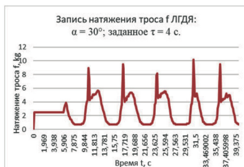
Рис. 3. Пример записи натяжения троса в одном из опытов
