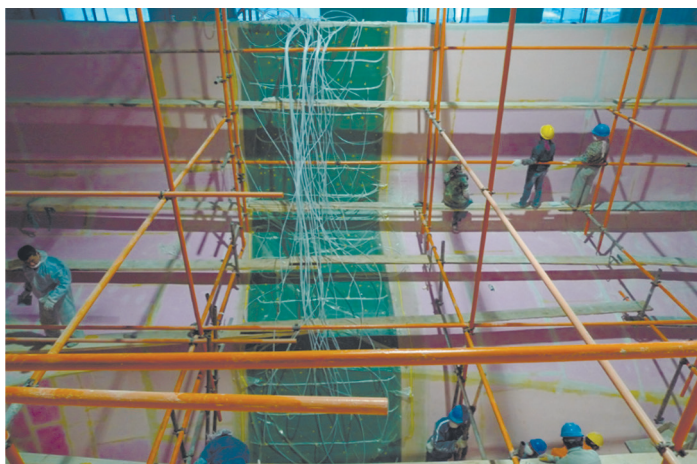
Рис. 2 Изготовление фрагмента обшивки корпуса судна методом инфузии
