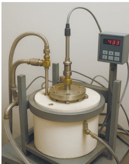
Рис. 2. Опытный образец камеры испытаний
