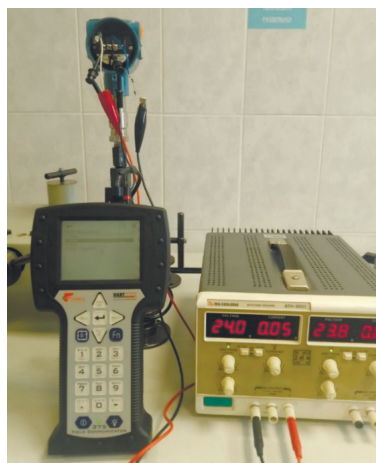
Рис. 2. Конфигурирование датчика избыточного давления «Метран-150 TG»
