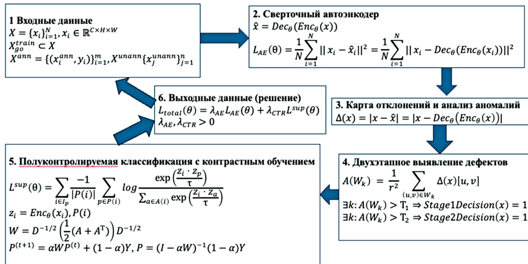
Рис. 2. Модель визуального контроля качества контролируемых объектов на основе гибридного полуконтролируемого обучения в интеллектуальной системе управления
