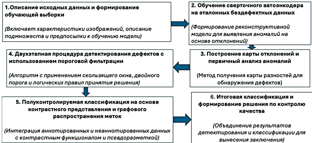
Рис. 1. Архитектура модели визуального контроля качества контролируемых объектов на основе гибридного полуконтролируемого обучения в интеллектуальной системе управления
