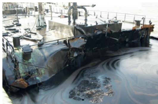
Рис. 2. Состояние корпусных конструкций в зоне перелома корпуса т/х «Волгонефть-239»: а — вид перелома со стороны борта; б — вид разрушения палубного настила (фото с сайта www.crimea-news.com )
