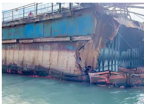
Рис. 2. Состояние корпусных конструкций в зоне перелома корпуса т/х «Волгонефть-239»: а — вид перелома со стороны борта; б — вид разрушения палубного настила (фото с сайта www.crimea-news.com )
