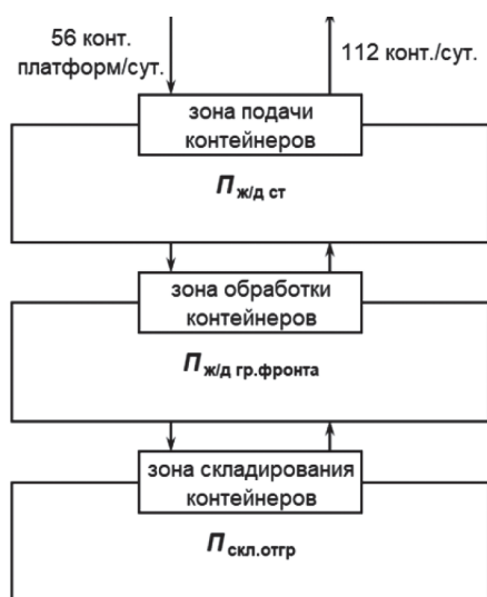
Рис. 1. Схема обработки грузов на железнодорожном грузовом фронте
