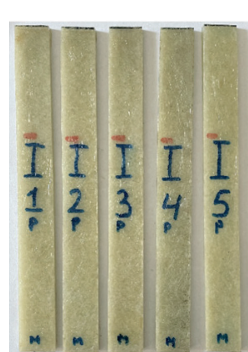
Рис. 3. Образцы двух разных схем армирования для испытания на растяжение: а — без обработки краев полиэфирной смолой; б — с обработки краев полиэфирной смолой
