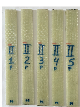
Рис. 3. Образцы двух разных схем армирования для испытания на растяжение: а — без обработки краев полиэфирной смолой; б — с обработки краев полиэфирной смолой
