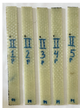
Рис. 3. Образцы двух разных схем армирования для испытания на растяжение: а — без обработки краев полиэфирной смолой; б — с обработки краев полиэфирной смолой
