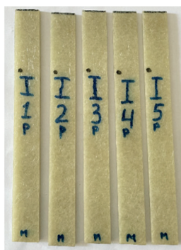
Рис. 3. Образцы двух разных схем армирования для испытания на растяжение: а — без обработки краев полиэфирной смолой; б — с обработки краев полиэфирной смолой
