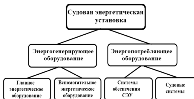
Рис. 1. Схема первичной разбивки оборудования [2]
