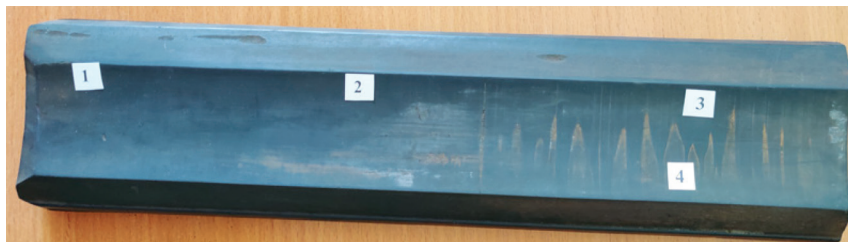
Рис. 6. Изношенная поверхность деталей дейдвудных подшипников, бывших в эксплуатации: а — капролоновой планки; б — резинометаллической планки
