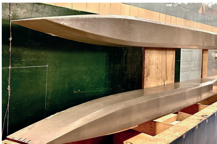
Рис. 2. Вид модели катамарана с упрощенными обводами
