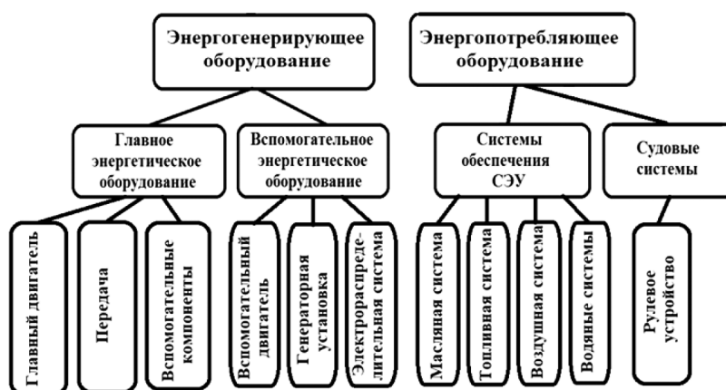
Рис. 2. Дополнительная разбивка оборудования СЭУ [2]
