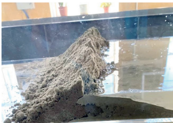
Рис. 8. Деформация насыпи (уровень воды в верхнем бьефе 40 \text{ мм} )
