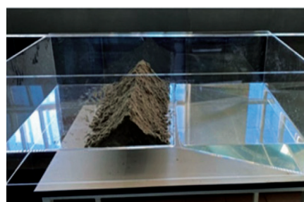
Рис. 7. Лабораторная установка по изучению подтопления грунта:
