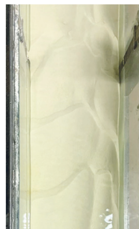
Рис. 3. Сформировавшийся грядовый рельеф дна: а — эксперимент 1; б — эксперимент 2
