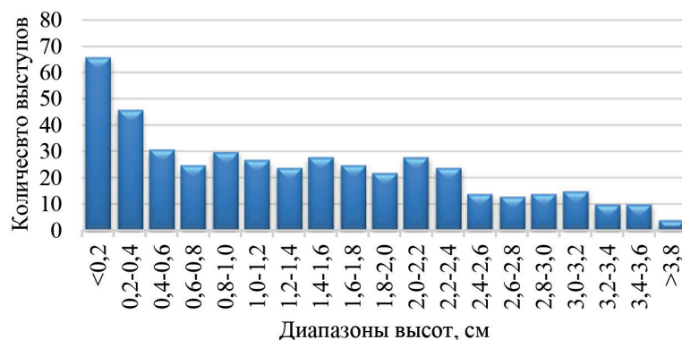
Рис. 4. Распределения выступов по диапазонам высот (эксперимент № 2)
