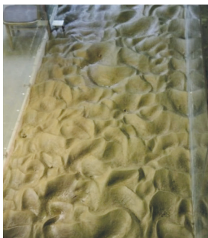
Рис. 3. Сформировавшийся грядовый рельеф дна: а — эксперимент 1; б — эксперимент 2
