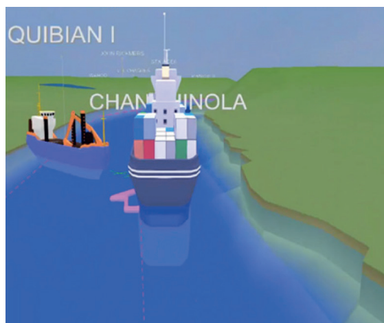
Рис. 3. Пример представления навигационной информации при смещении судна с оси подходного канала шлюза в 3D ЭНК при положении точки наблюдения вне судна
