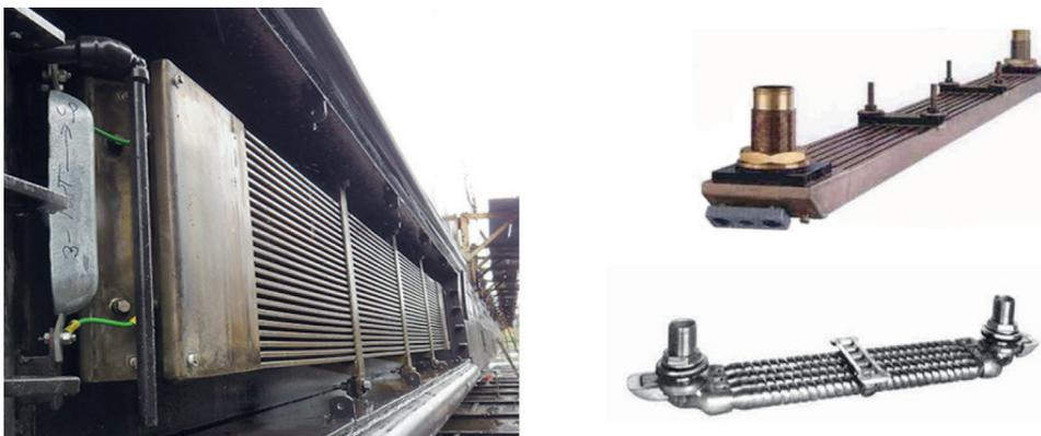
Рис. 1. Секционные теплообменники
