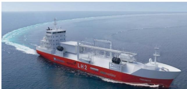
Рис. 6. Проект водородовоза LH<sub>2</sub> (Kawasaki Heavy Industries, Ltd.) (а) и проект бункеровщика LH<sub>2</sub> (Moss Maritime) (б)
