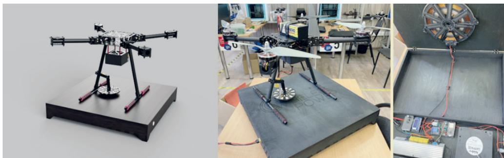
Рис. 4. Итоговая аппаратная сборка комплекса для зарядки беспилотных авиационных систем с учетом приемного модуля с катушкой на борту, наземной системой посадки и зарядки
