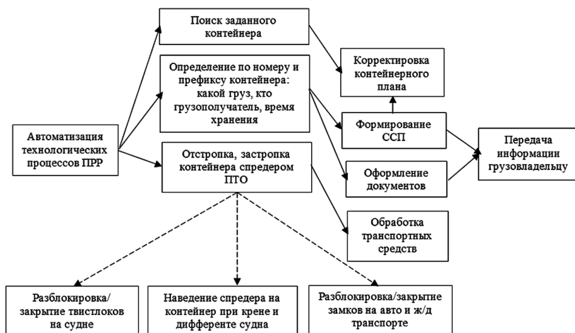
Рис. 4. Технологические процессы КТ, выполняемые в автоматизированном и ручном режимах работы: —————> — автоматизированный режим работы; - - - - -> — ручной режим работы
