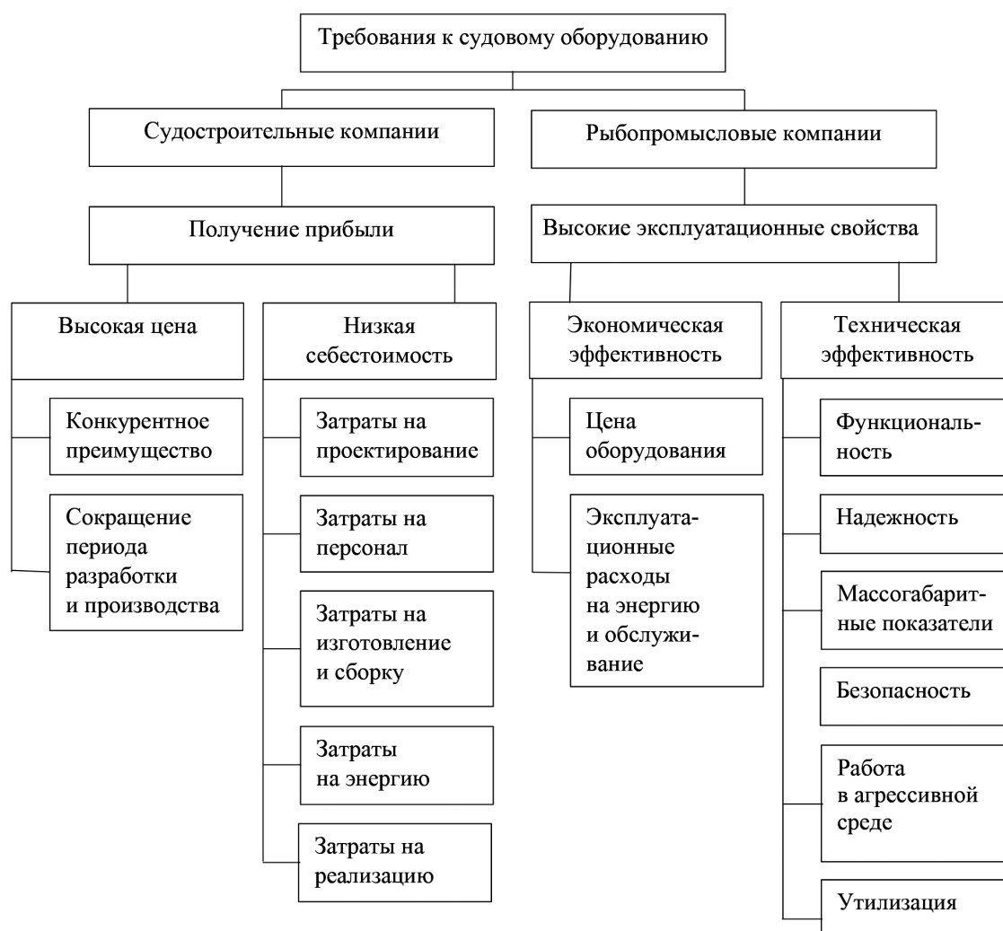
Рис. 3. Схема требований к судовому оборудованию судостроительных и рыбопромысловых компаний Fig. 3. Scheme of requirements for ship equipment of shipbuilding and fishing companies
