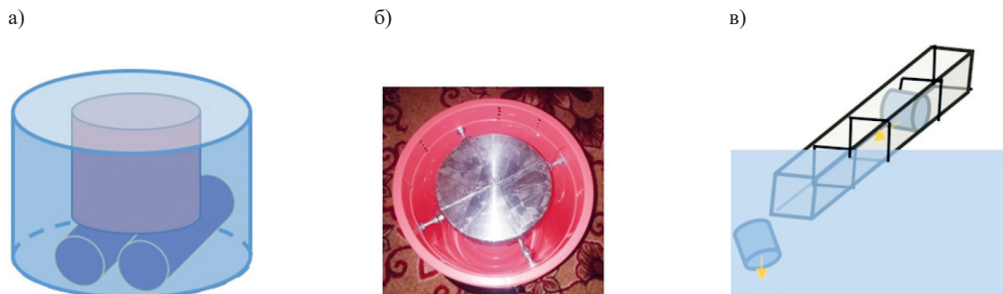
Рис. 5. Концепция донной станции без оставления груза на дне (а), ее модель, выполненная из пластикового ведра и груза (вид сверху) (б), графический вид метода погружения станции на дно (в) Fig. 5. The concept of a bottom station without leaving a load at the bottom (a), its model made of a plastic bucket and a load (top view) (b), a graphical view of the method of immersing the station to the bottom (c)
