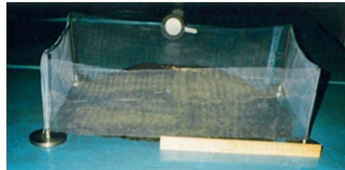
Рис. 5. Фото модельных штабелей с углем:
