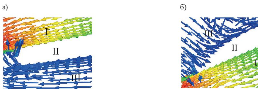
Рис. 3. Распределение скоростей потока на границе с носовой частью 1 (а) и носовой частью 2 (б): I — поток воды в канале форсунки; II — стенка форсунки; III — поток снаружи форсунки
