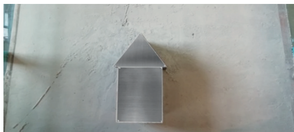
Рис. 5. Короб с ледорезом, подготовленный к пропуску воды (фото авторов)
