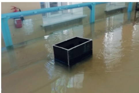
Рис. 3. Испытание с коробом без ледореза (фото авторов)
