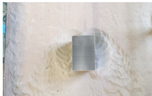
Рис. 4. Структура рельефа дна после прокачки (фото авторов)
