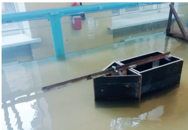
Рис. 2. Модель шпунтового короба под защитой ледореза, который может быть размещен в русле реки (фото авторов)
