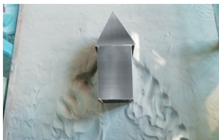
Рис. 10. Структура дна вдоль следа подковообразного вихря
