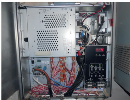
Рис. 5. Вид блока VDR (а) и схема подключения к компьютеру (б) (Источник заимствования: Инструкция VDR FURUNO VR 3000)
