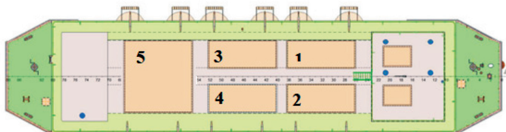
Рис. 8. Плавающая лаборатория «Судовая зеленая энергетика»: а — вид правого борта; б — вид сверху (1 — лаборатория рабочих процессов газовых и газодизельных двигателей; 2 — лаборатория экологических проблем судовой энергетики; 3 — лаборатория газового и криогенного оборудования; 4 — лаборатория пожаро- взрывобезопасности судового оборудования; 5 — лекционная аудитория)
