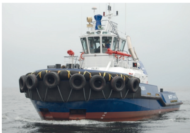
Рис. 9. Усиление кранцевой защиты в носовой части автомобильными покрышками
