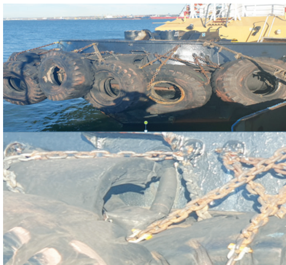
Рис. 11. Вариант временного решения при повреждении носового кранца
