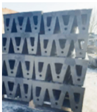
Рис. 6. Элементы кранцевой защиты: а — W-образные; б — М-образные кранцы
