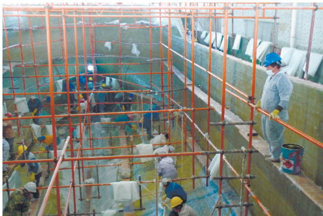
Рис. 1. Процесс формовки обшивки в матрице методом контактного формования
