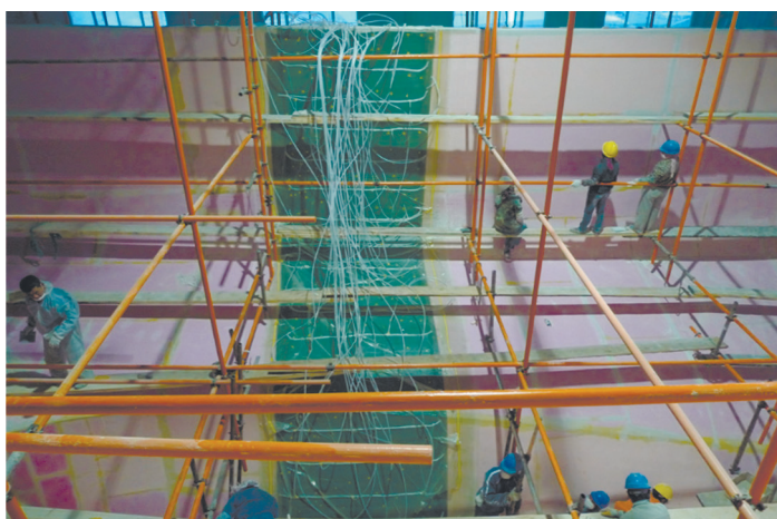
Рис. 2 Изготовление фрагмента обшивки корпуса судна методом инфузии
