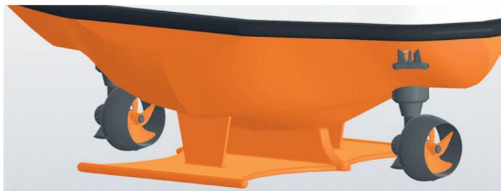
Рис. 3. Внешний вид пропульсивной системы БА
