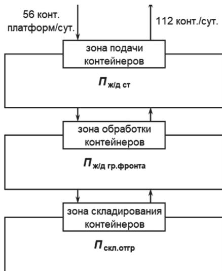
Рис. 1. Схема обработки грузов на железнодорожном грузовом фронте
