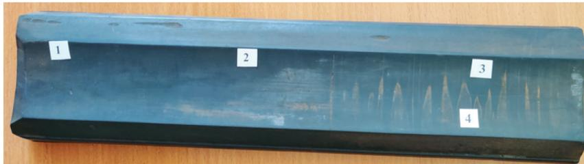
Рис. 6. Изношенная поверхность деталей дейдвудных подшипников, бывших в эксплуатации:
