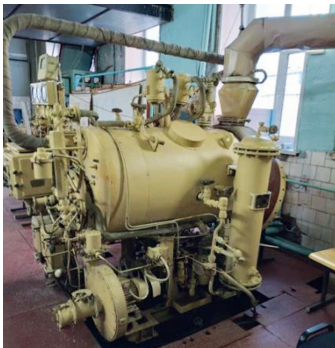
Рис. 1. Экспериментальный стенд с котлоагрегатом КВС-200
