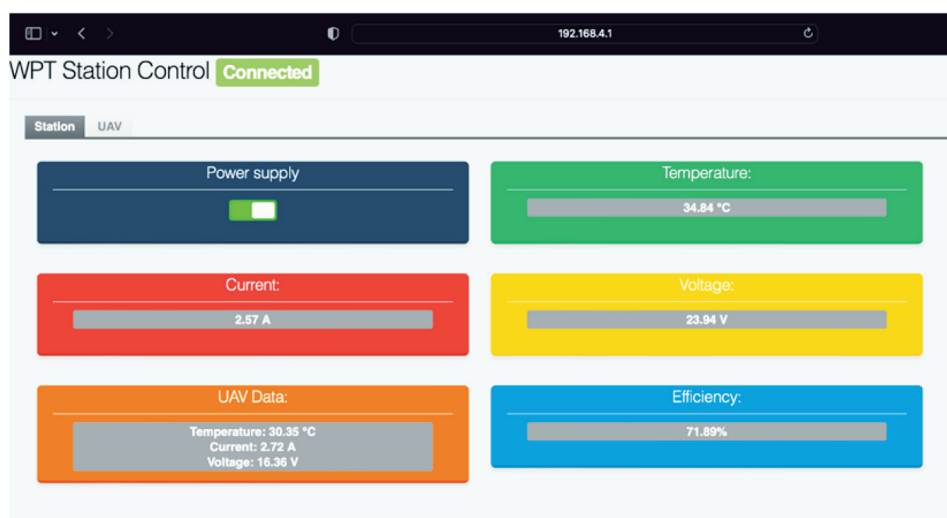
Рис. 5. Графический интерфейс веб-сервера с отображением всех параметров и расчетом коэффициента полезного действия
