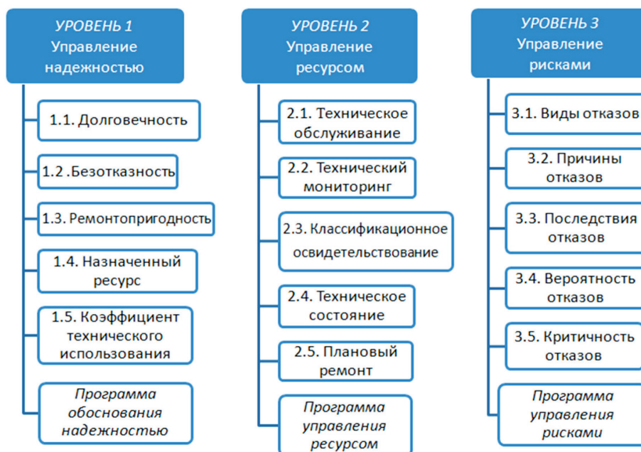
Рис. 3. Многоуровневая система обеспечения надежности судовых механических систем на этапах жизненного цикла
