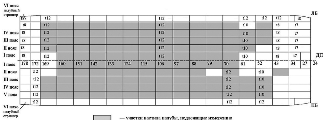
Рис. 2. Пример оформления карты замеров остаточных толщин настила главной палубы Fig. 2. An example of drawing up a map of measurements of the residual thicknesses of the main deck plate
