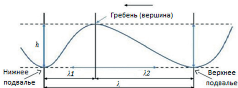
Рис. 1. Идеализация продольного сечения двухмерной гряды (движение потока справа налево)
