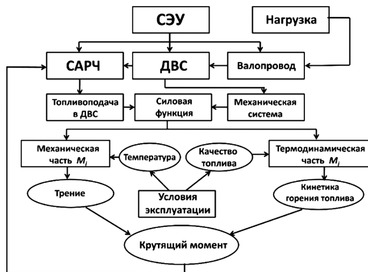
Рис. 1. Структурная схема СЭУ
