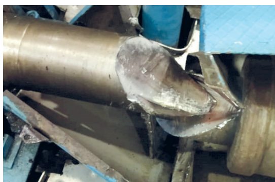
Рис. 2. Поломка МДК буксира типа «ОТ» пр. 428.2
