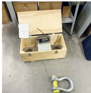
Рис. 6. Динамометр АЦД/1Р-250/7И-2: а — комплектация; б — электронный блок прибора
