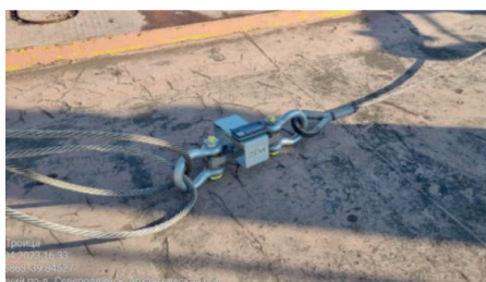
Рис. 8. Установка динамометра АЦД/1Р-250/7И-2 на судах:
