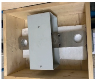
Рис. 7. Силовые элементы динамометра: а — упругий элемент; б — силовводящий элемент
