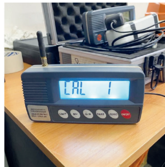
Рис. 6. Динамометр АЦД/1Р-250/7И-2: а — комплектация; б — электронный блок прибора
