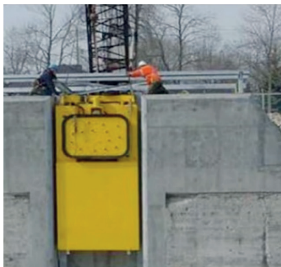
Рис. 5. Испытания вакуумного автошвартовного устройства на шлюзах Уэллендского канала в Канаде:
