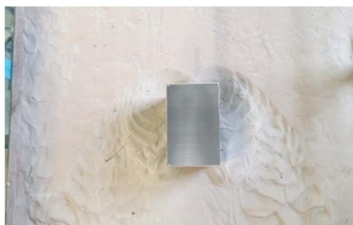
Рис. 4. Структура рельефа дна после прокачки (фото авторов)
