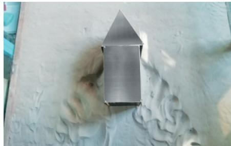
Рис. 10. Структура дна вдоль следа подковообразного вихря
