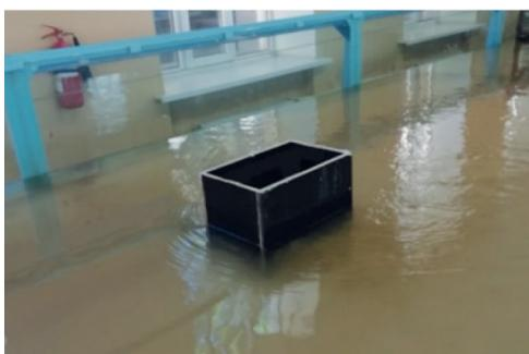
Рис. 3. Испытание с коробом без ледореза (фото авторов)
