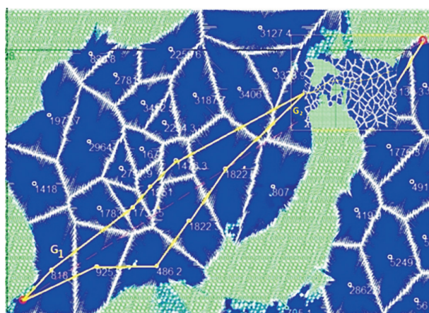
Рис. 4. Гиперграф маршрута судна на основе кластеризации глубин
