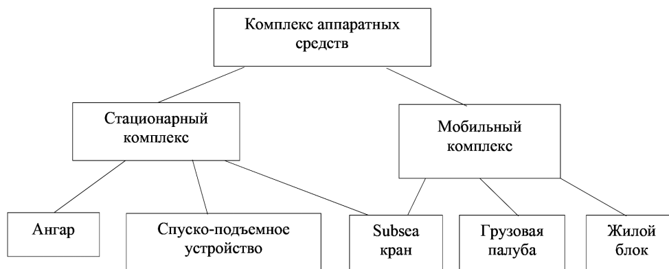
Рис. 8. Структурная схема необходимых конструктивных особенностей судов обеспечения подводно-технических работ для функционирования аппаратных средств
