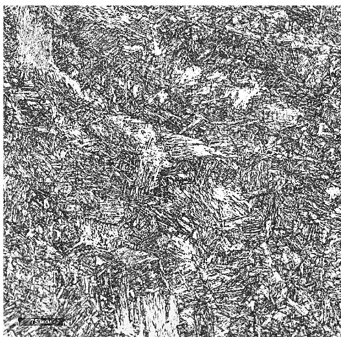
Рис. 3. Бейнитно-мартенситная структура в зонах перегрева и нормализации в верхней части z/H = 0,1 сварного соединения: а — зона крупного зерна; б — зона мелкого зерна
