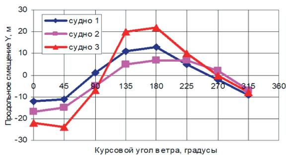
Рис. 2. Зависимость поперечного и продольного смещения точки поворота на 270° от курсового угла ветра скоростью 20 м/с
