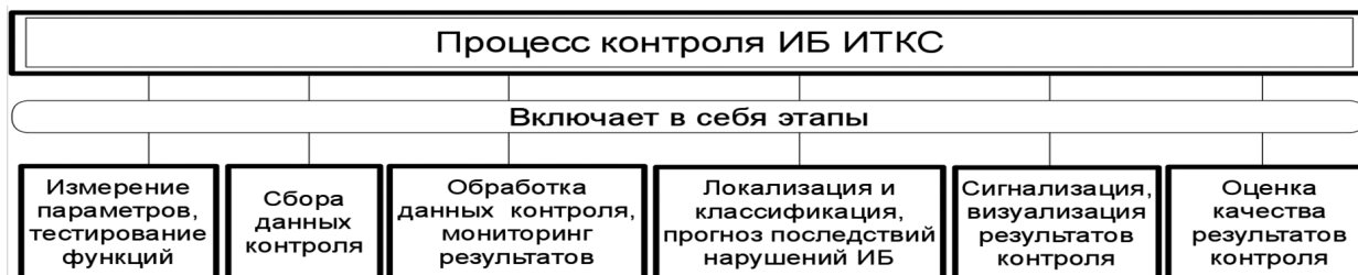
Рис. 5. Традиционная схема процесса контроля ИБ ИТКС.
