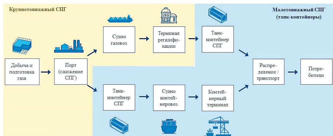
Рис. 6. Логистическая цепочка поставки СПГ с использованием танк-контейнеров
