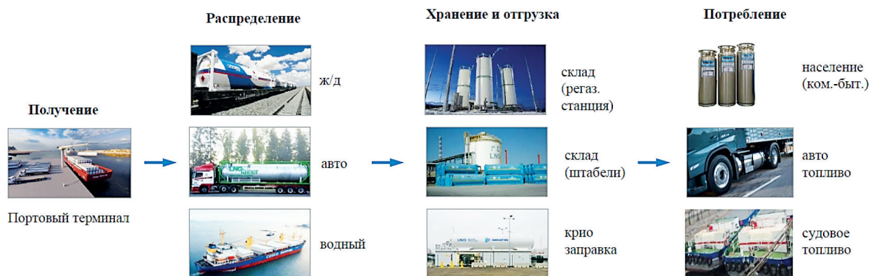
Рис. 7. Распределение танк-контейнеров от портового терминала до потребителя
