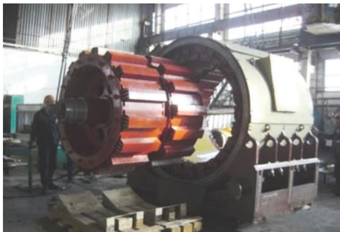
Рис. 9. Вентильно-индукторный гребной электродвигателя в процессе изготовления
