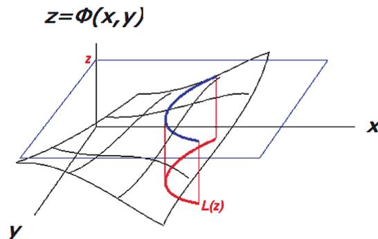
Рис. 2. Линия пересечения поверхности  $\Phi(x, y)$  плоскостью  $z_0$
