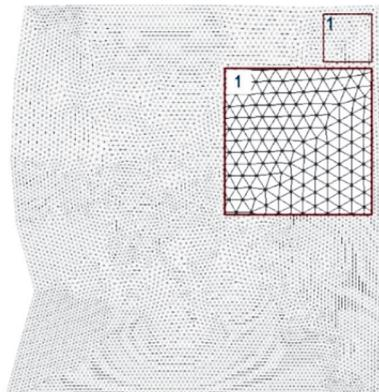
Рис. 3. Расчетная треугольная конечно-элементная сетка для моделируемого участка р. Зеи
