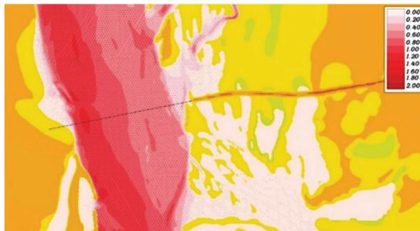
Рис. 6. Поле средних скоростей течения по результатам гидравлических расчетов, м/с (бытовое состояние)
