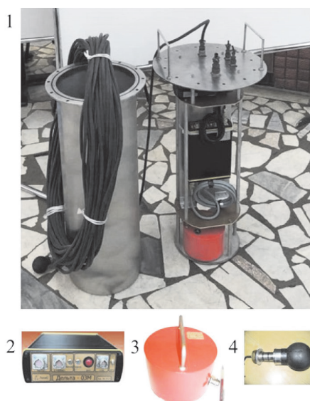
Рис. 3. Наледная сейсмостанция и ее основные комплектующие:
