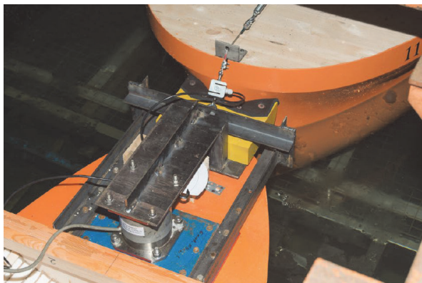
Рис. 2. Расположение буксирного каната на модели (а) и в натурных условиях (б)
