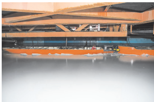
Рис. 3. Фрагмент экспериментальных исследований буксировки вплотную в ровном льду при наблюдении из камеры ледового бассейна (а) и через подводные иллюминаторы (б)
