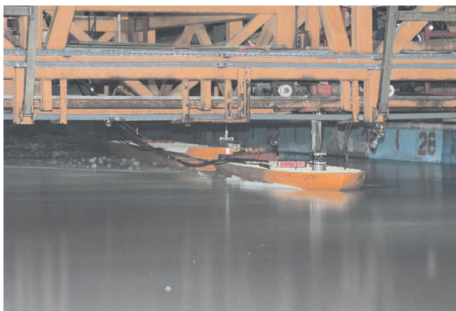
Рис. 5. Циркуляция сцепки во льдах толщиной 1 м со скоростью 4 уз в пересчете на натурные условия
