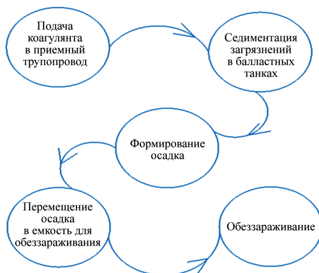
Рис. 2. Технология очистки и обеззараживания балластной воды
