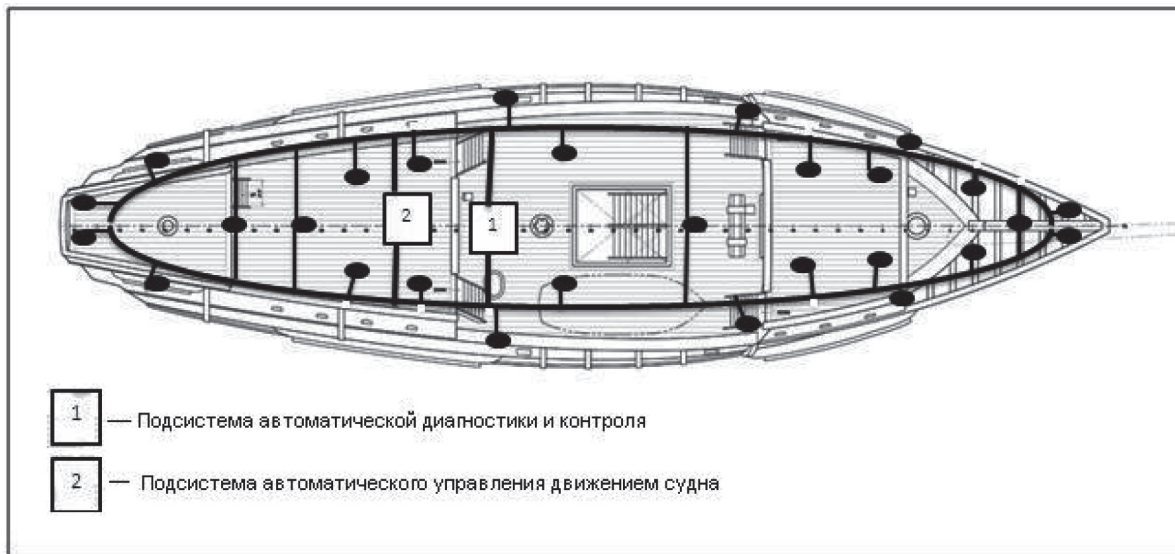
Рис. 2. Структура связей компонентов автоматической системы управления по мультиплексным каналам
