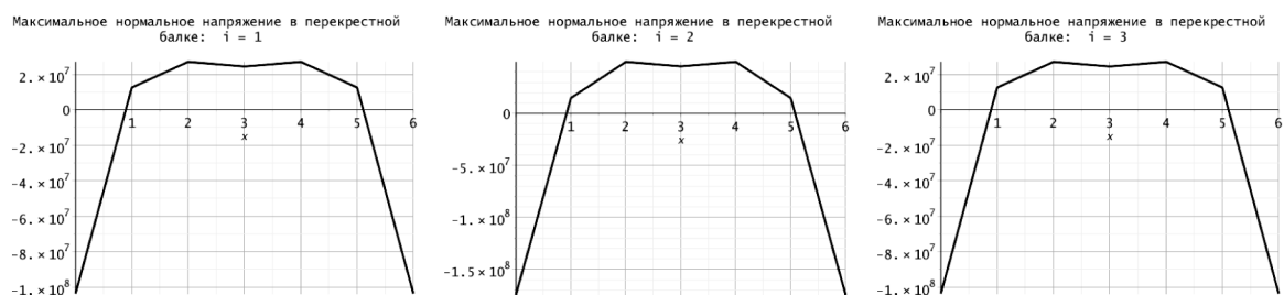
Рис. 5. Эпюры нормальных напряжений в перекрестных балках
