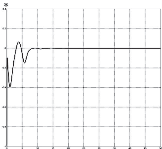
Рис. 5. Отклонение сигнала на выходе настраиваемой модели от сигнала на выходе объекта для нелинейной модели Норбина
