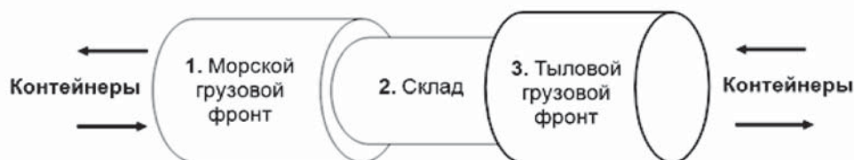
Условная схема технологических элементов портового контейнерного терминала
