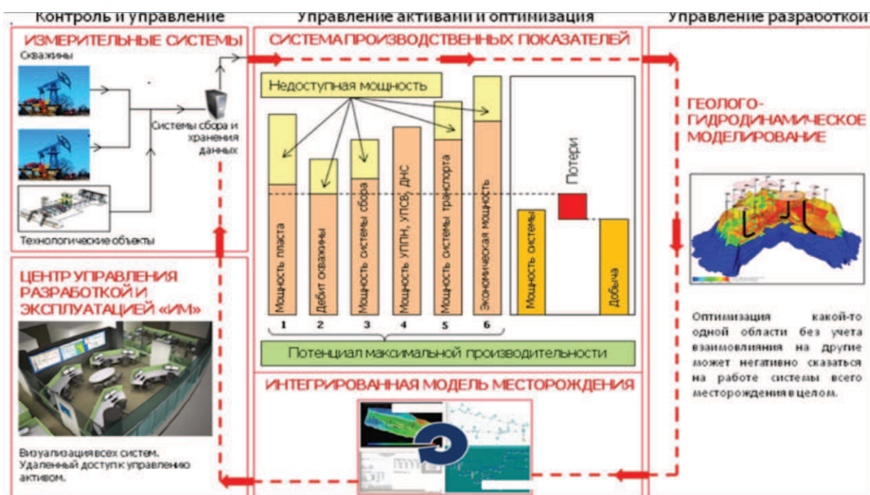
Рис. 1. Интегрированная модель получает в реальном времени параметры эксплуатационных объектов, обрабатывает и выдает варианты управленческих решений, направленных на снижение разницы между плановой и фактической добычей нефти (иллюстрация А. Власова [1])
